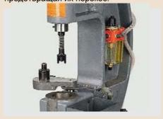
Дополнительное поворотное приспособление облегчает работу со сдвоенными колодками.
