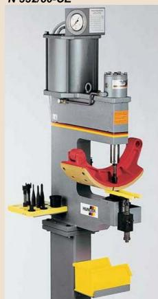
Модель N 332/80-СЕ имеет увеличенный ход штока 80 мм и глубину зазора 230 мм. Это особенно удобно при работе с колодками, имеющими сдвоенные ребра. Увеличенная глубина зазора позволяет клепать задний ряд заклепок без переворачивания тормозных колодок.
